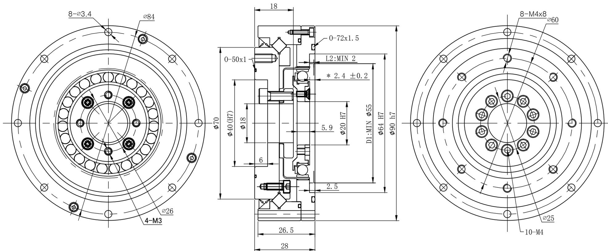
L2/D1: 与刚轮安装零件避免干涉的最小安全尺寸
